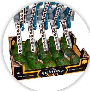
**BCAP** - La BCAP è un sistema polivalente destinato all'etichettatura di frutta e verdura in cassette e alveoli. Il telaio di acciaio è fissato direttamente sul nastro trasportatore. L'etichettatura viene eseguita attraverso un dispositivo automatizzato con encoder che riconosce la posizione del frutto da etichettare ed una fotocellula di posizionamento per la visualizzazione della cassetta o dell'alveolo.
